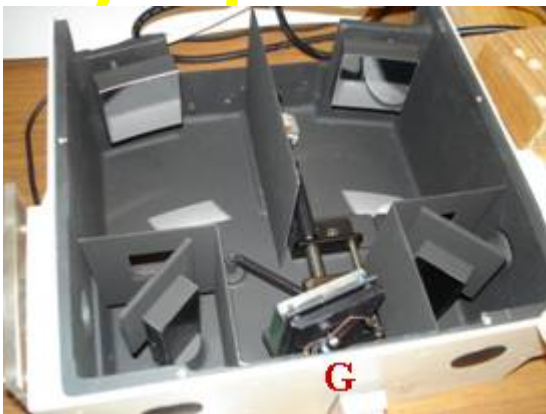
Μονοχρωμάτορας G: φράγμα περίθλασης
